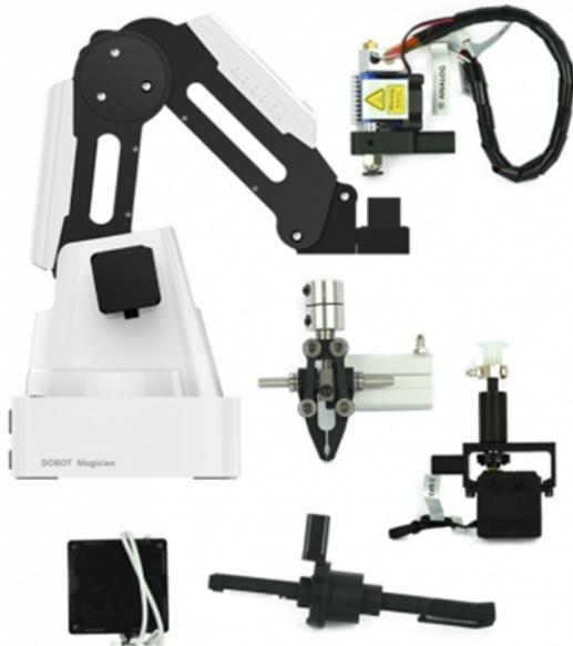
Многофункциональный робот **Dobot Magician** представляет собой роботизированную "руку", которая может печатать 3D-фигуры, выполнять лазерную гравировку, воспроизводить на бумаге различные чертежи, схемы и рисунки, а также манипулировать предметами.
